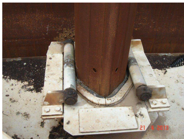
הצינור המוביל נע באמצעות Guide Rollers.
